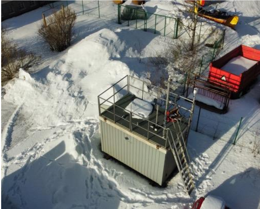
Kuva 29. Ilmanlaadun mittausasema Heinolan Tommolassa kaupungin varikon laidalla. Ulkoilma imetään mittalaitteisiin kontin katolla sijaitsevien näytteenottimien läpi. Lisäksi katolla on säämittausanturi. Valokuva: Mika Vestenius.
