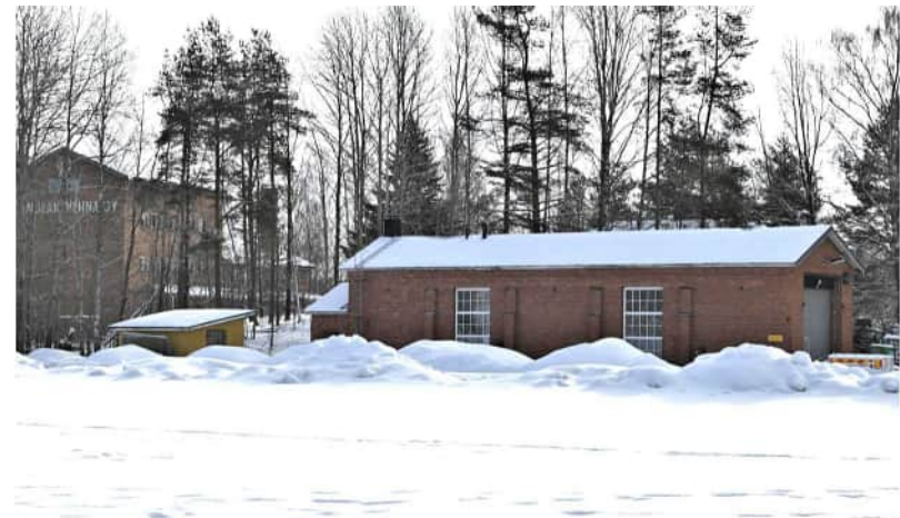
Kuva: Suunnittelualueen ulkopuolelle jää ratapihan itäpuolella sijaitseva yksipilttuinen veturitalli vuodelta 1931. Rakennus on muurattu tiilestä. Rakennuksesta on 2010–11 uusittu päädyn ovi (nosto-ovena), ikkunat (karmijako vaihdettu, rimointu alkuperäisen kaltainen) ja vesikatto (profiilipelti, edellinen huopaa; savutorvet poistettu). / Moottorivaunuvaja, arkkitehti Jarl Ungernin piirustus nro 1853, pohja, 2 leikkaus, 3 julkisivu. Muutostöimenpiteitä oli tehty mm. 1942.
